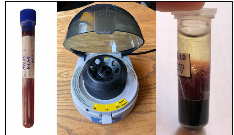
Fig. 17. Imágenes del tratamiento de sangre: Izquierda - Sangre con anticoagulante; Centro - Centrifuga; Derecha - Muestra centrifugada.
